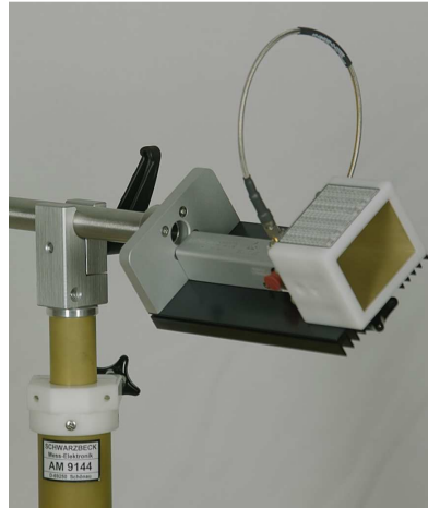
Bild 3 Montagebeispiel 45° Figure 3: mounting example 45°
