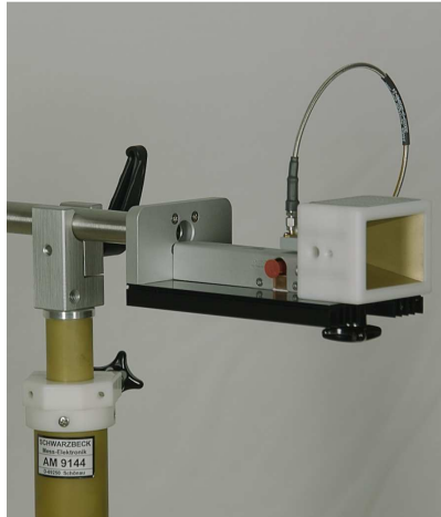
Bild 2 Montagebeispiel vertical Figure 2: mounting example vertical
