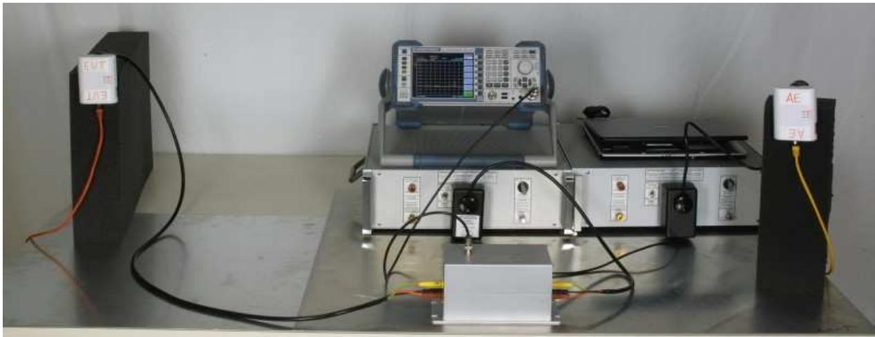
Abb. 8: Praktischer Messsaufbau nach Kapitel 9.4 EN-50561-1, Abbildung 6
