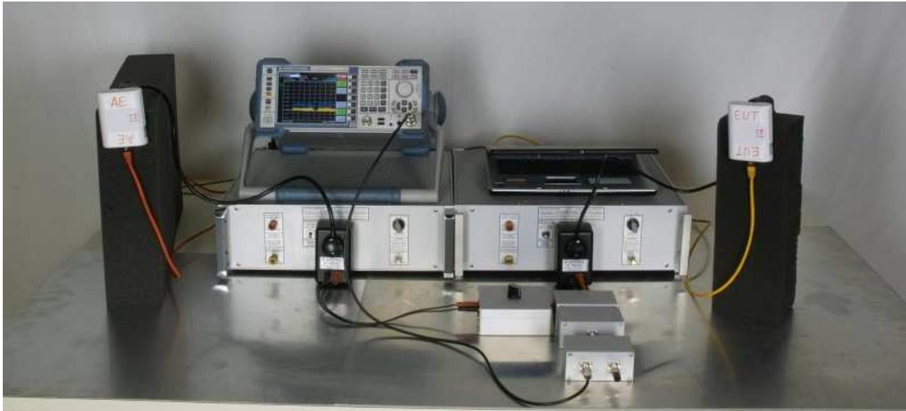
Abb. 4: Messsaufbau nach Kapitel 9.2 der EN-50561-1
