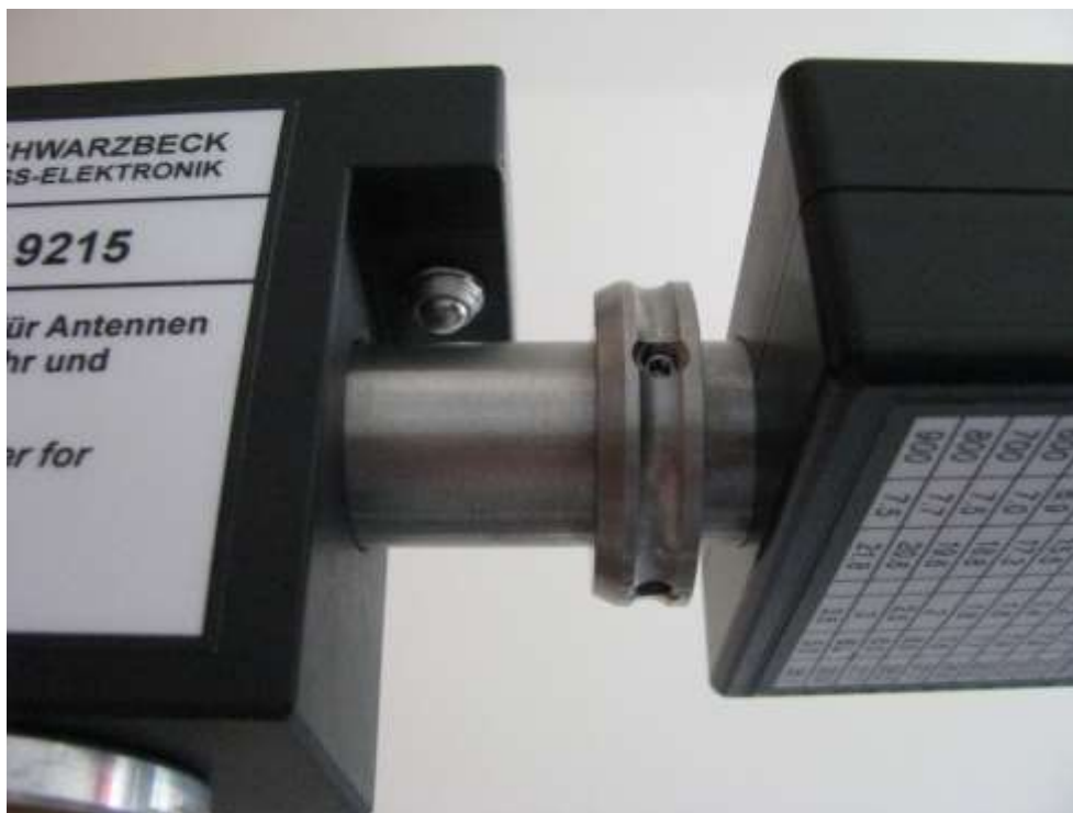
Fig. 2: Detail RA 9215 und Rastring Detail RA 9215 and indexing ring
